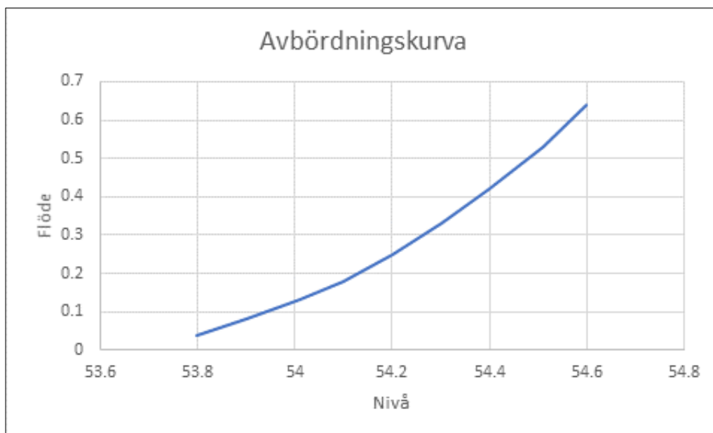
Figur 30. Avbördningskurva som visar sambandet mellan vattennivån (RH 70) i sjön och flödet (m³) i omlöpet.
