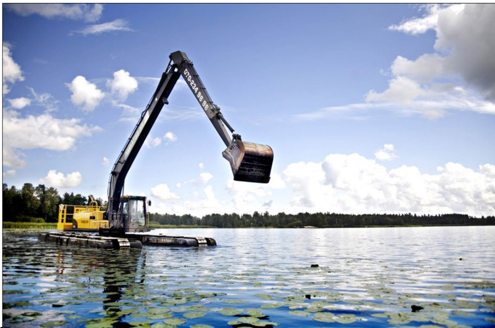
Figur 9. Amfibiegående grävmaskin (foto Maxtech AB, Saltsjö-Boo).
