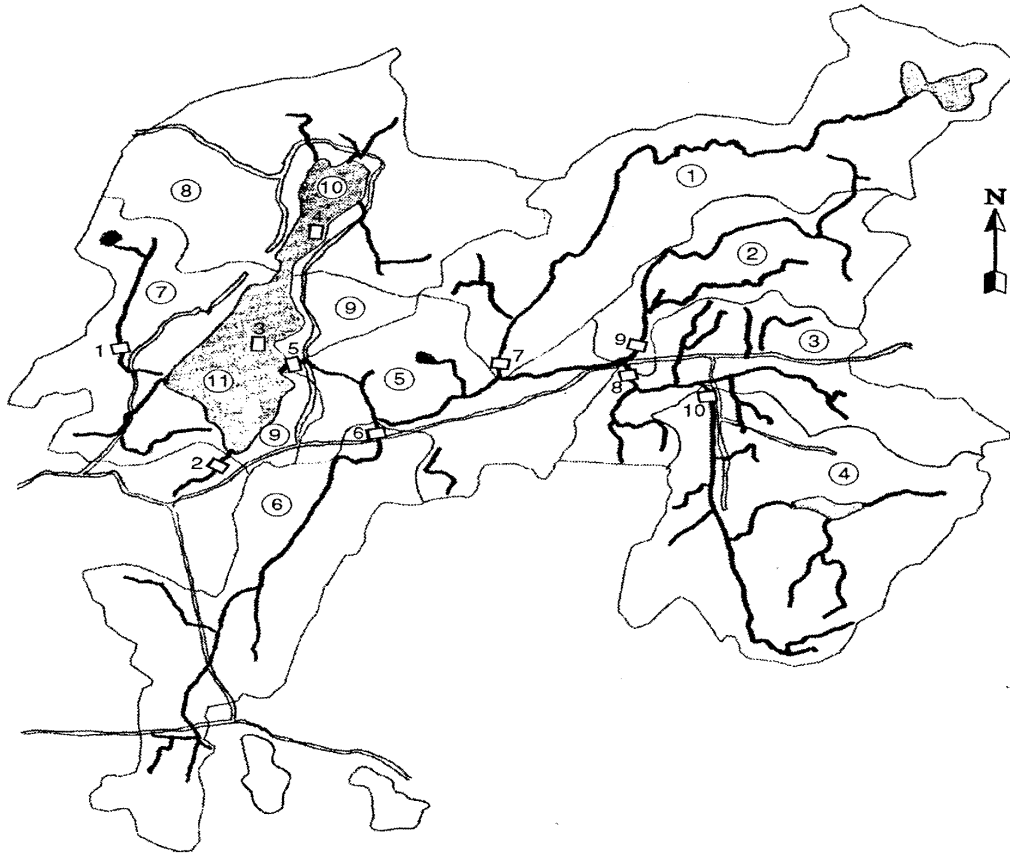
Figur 1. Schematisk karta över avrinningsområdet indelat i delavrinningsområden. Större vattendrag sjöar och vägar är utmärkta liksom provtagningspunkter (pkt. 1 till 10) och delavrinningsområden (1-11 i ringar). Illustration från "Flöden av kväve och fosfor i avrinningsområdet Vansjön-Nordsjön", Carina Carlsson 1999.
