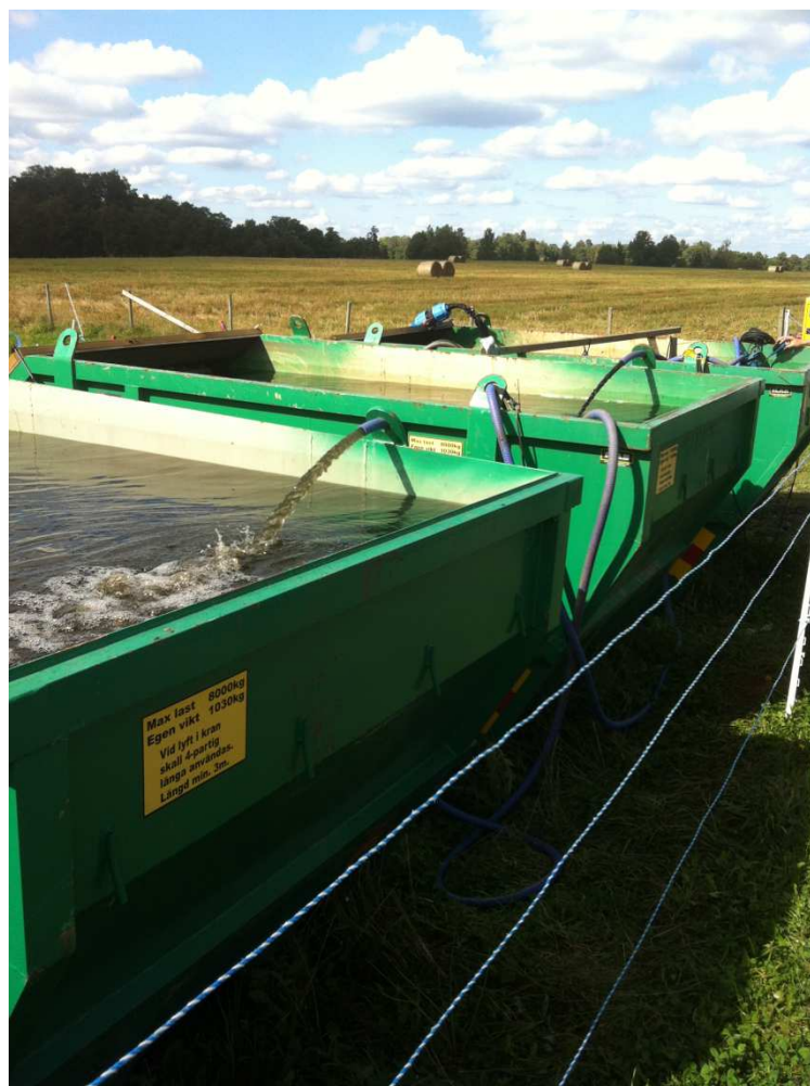
Figur 3 Separationstankar för separation av vatten
